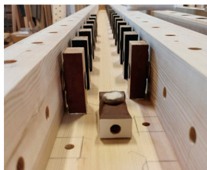
Ny vindlade med gjenbruk av Witzig-belger fra Levanger
